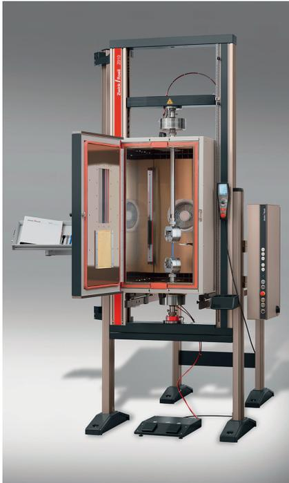
Universalprüfmaschine Z10 AllroundLine mit Temperierkammer für Zugversuche an Kunststoffen © ZwickRoell
