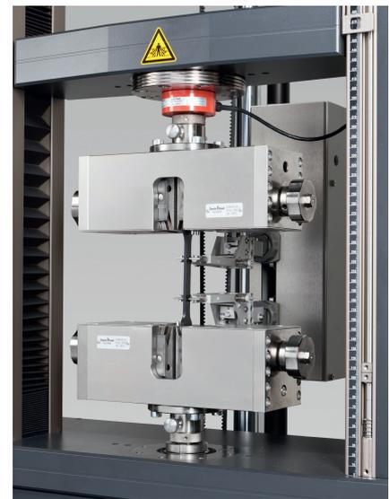
Das makroXtens II ist ein universell für Zug-, Druck-, Biege- und zyklische Prüfungen einsetzbares Fühler-Extensometer mit hoher Auflösung © ZwickRoell
